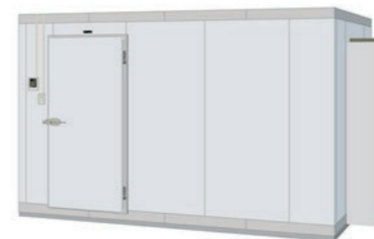
プレハブ冷凍庫 1.0坪 K64-2 外形寸法 W1800+(600)×D1800+(120)×H2260mm (坪数1.0坪/3.3㎡) 使用温度 -25℃~-5℃ 電 源 単相100V400W 三相200V2.47KW ※電源は両方必要です
