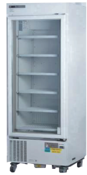
2尺冷凍・冷蔵切替リーチインショーケース 100V K31-1 外形寸法 W610×D680×H1954mm 有効内容積 355ℓ (定格内容積209ℓ) 使用温度 -22℃~-10℃ 電 源 単相100V693W ※冷凍・冷蔵切替タイプ
