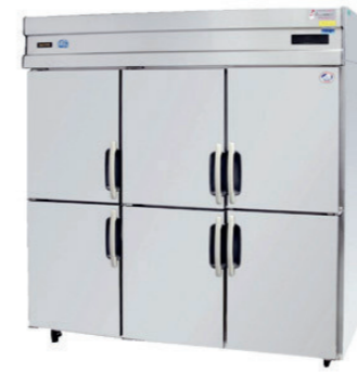
6尺業務用冷凍庫 三相200V 0.54KW K35-3 外形寸法 W1800×D800×H1950mm 有効内容積 1659ℓ、6ドア 使用温度 -25℃~-15℃ 電 源 三相200V554W
