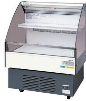
3尺冷蔵ヒナ段ショーケース (R) K1-4 外形寸法 W900×D750×H1200mm 有効内容積 156ℓ 使用温度 7℃~12℃ 電源 単相100V587W ※連結使用もできます
