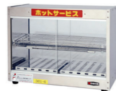
ホットショーケース(2段)W600 K36-1 外形寸法 W600×D300×H460mm 使用温度 30°C~90°C 電 源 単相100V430W
