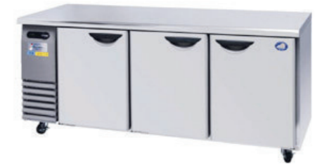
6尺冷凍コールドテーブル K45-3 外形寸法 W1800×D600×H830mm 有効内容積 406ℓ、3ドア 使用温度 -20℃ 電 源 単相100V400W
